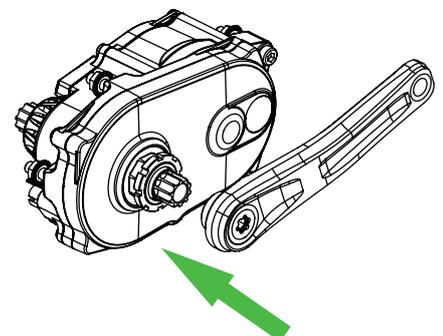
**005** À l'aide d'une clé Allen de 8 mm, vissez l'écrou de manivelle dans le filetage de l'axe. Faire attention de bien démarrer le filetage avant de le serrer à fond. L'écrou doit tourner librement et tirez la manivelle sur la première partie de la cannelure avec une résistance minimale.
